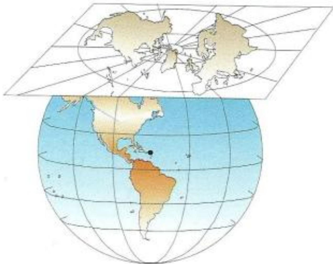
Principio della proiezione polare.
